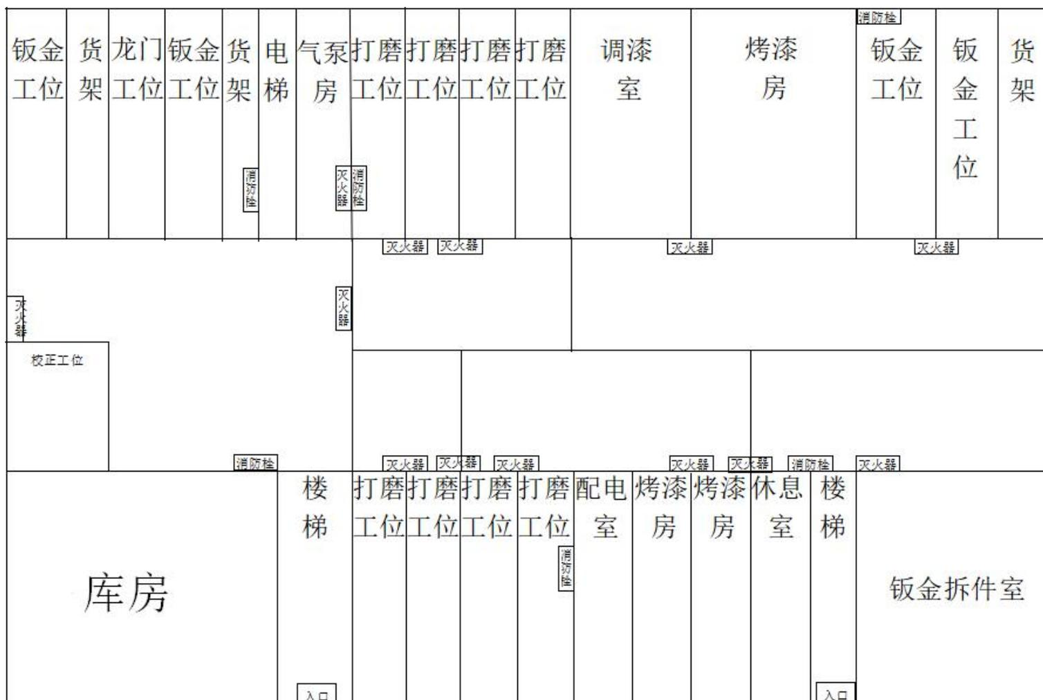
图 2.1-3 汽车修理车间二层平面图
