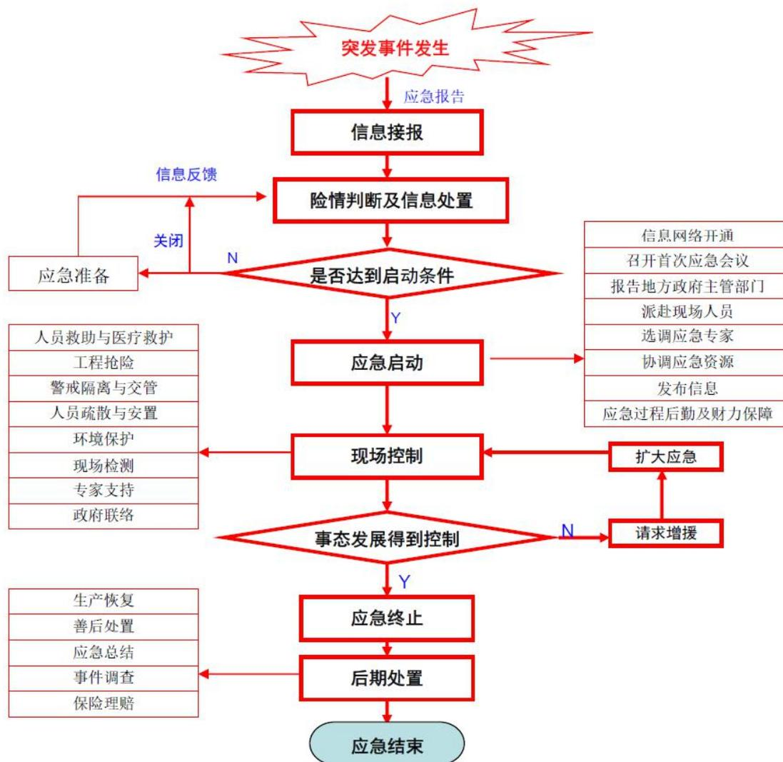
图 7.2-1 应急响应流程图
